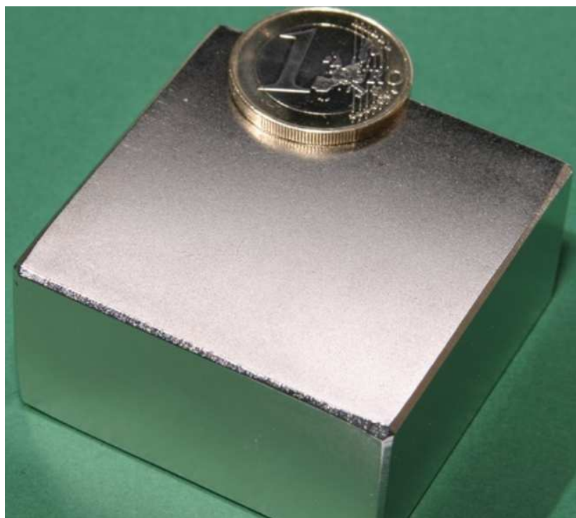
Obr. 5-2 Blok NdFeB magnetu s povrchovou úpravou niklováním [10].
