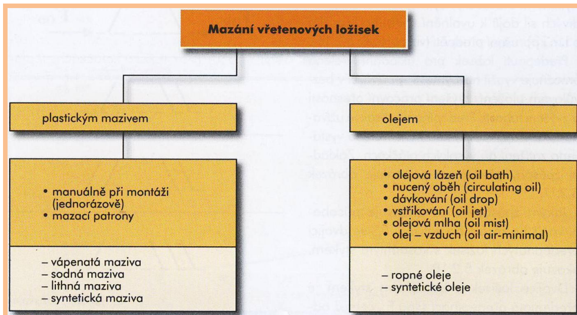
Obr. 8.27 Způsoby mazání vřetenových ložisek [4]
