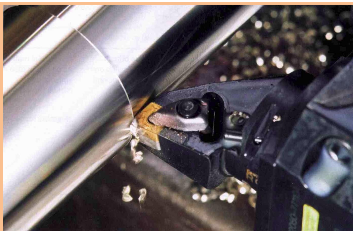
Obr. 3.2 Vznik třísky [10]
