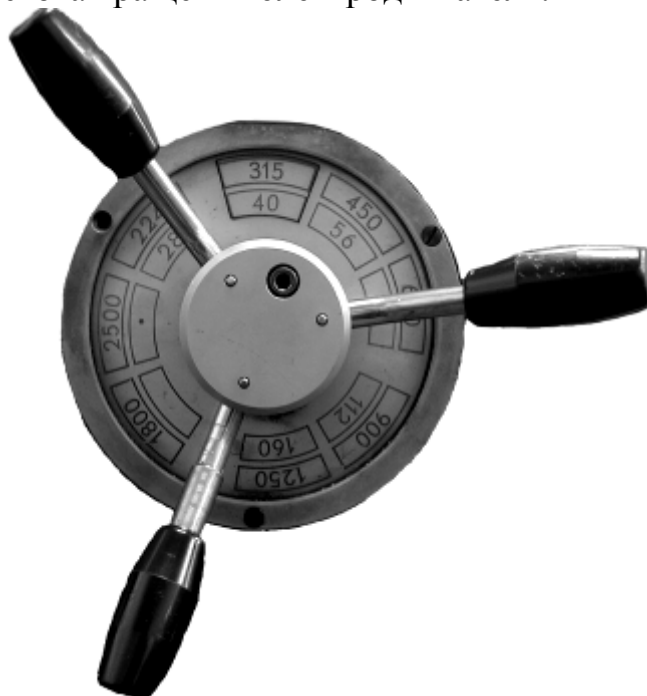
Рис. 2.4. Штурвал установки частот вращения шпинделя
