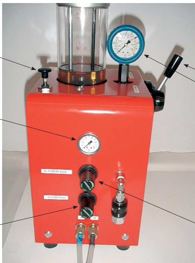
Ovládací ventil s tlakoměrem pro měření hydraulického tlaku
